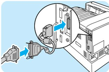
オプション品に同梱されているコネクタ変換ケーブルを本体に接続し、コネクタ変換ケーブルの他方のコネクタにパラレルケーブルを接続します。
