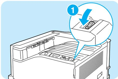
1 プリンターの上面右側にある電源スイッチの〈O〉側を押し、電源を切ります。
