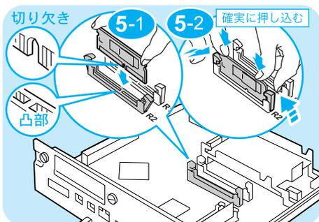
R2 スロットの両側にあるツメを大きく開いたあと、切り欠き部分を本体側の R2 スロットの凸部に正しく合わせて、まっすぐに差し込み、さらに両側を上から強く押します。
