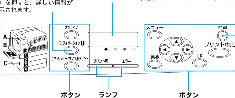
**〈節電〉** はボタンとランプの機能を持っています。節電モード (スリープモード) になると、操作パネルは、このランプだけが点灯します。
