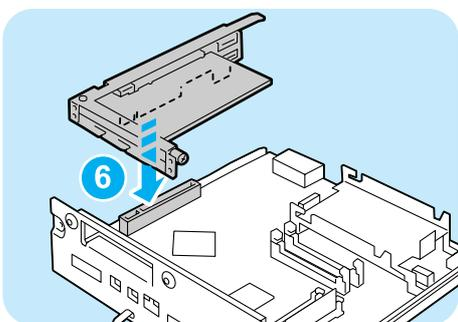
6 パラレルインタフェースカード（フレーム付き）とコントローラーボードのコンネクターを合わせて、上から差し込みます。
