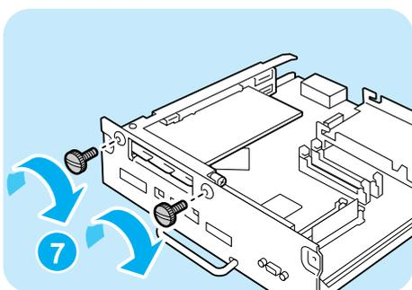
7 手順 5 で外したネジで、外側からパラレルインタフェースカードを固定します。
