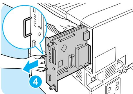
4 コントローラーボードの取っ手を引き出したら、取っ手を持ってコントローラーボードをゆっくり取り出し、机などの平らな場所に置きます。
