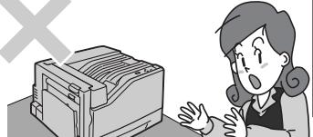
火災・感電の原因となります。雷が発生しそうなときは電源プラグをコンセントから抜いてください。また雷が鳴りだしたらケーブル類も含めて装置には触らないでください。
