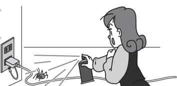
電源コードに殺虫剤などの薬品類をかけないでください。コードの被覆が劣化し、感電や火災の原因となることがあります。
