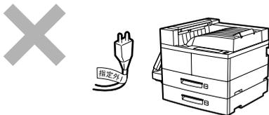
プリンターに添付されている電源コード以外のコードを使わないでください。電源コードに定格以上の電流が流れると、火災になるおそれがあります。
