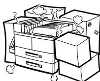
プリンターの周りに物を置いてプリンターの通気孔をふさがないでください。また排気孔の上に物をのせないでください。プリンター内の温度が異常に高くなり、正しく動作しなくなることがあります。
