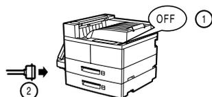
プリンターケーブルやオプションの取り付け、取り外しを行う前に電源スイッチをOFFにしてください。電源が入ったまま行くと誤動作するようになり、故障することがあります。
