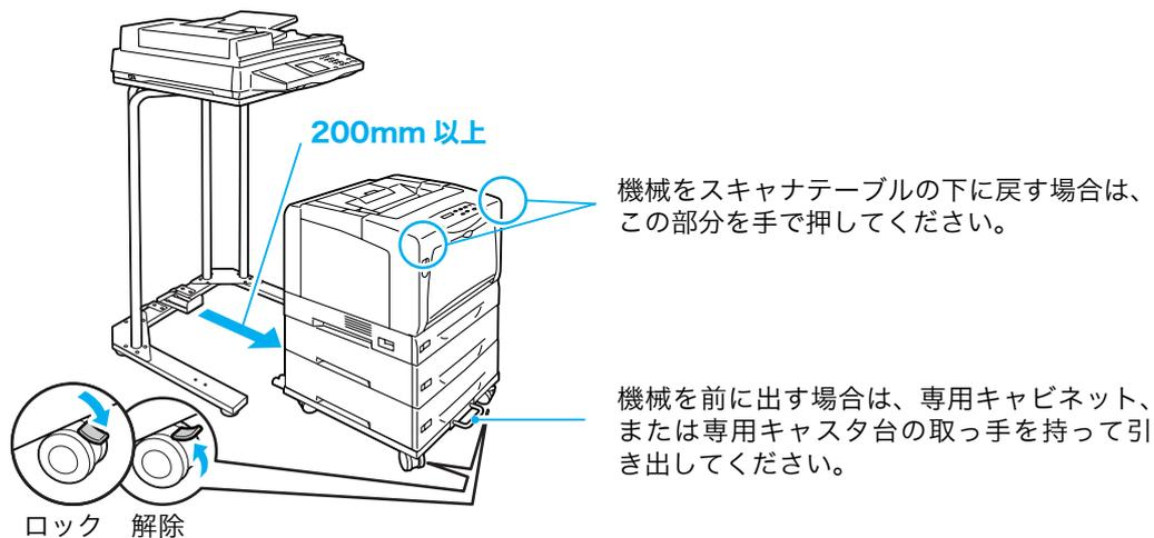
2. オプション品を取り付ける場合は、背面カバーを開けて作業するため、本機をスキャナテーブルから 200mm 以上手前に引き出し、さらに、90° 回転させてください。
