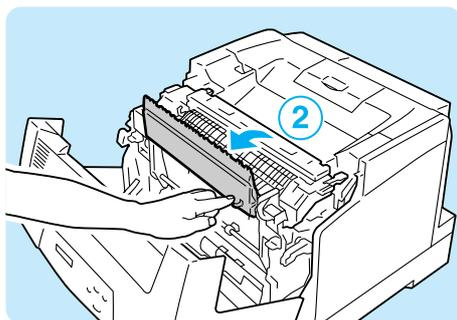
2 フューザーユニットの内部に用紙があるときは、右側の突起部分を持って、両面印刷ユニットのカバーを開けます。
