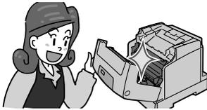
このプリンターはレーザー（レーザーダイオード）を使用しています。電源がONになっているときに内部をのぞいたり、鏡などを差し込んだりしないでください。万一、レーザー光が目に入ると失明するおそれがあります（レーザー光は目に見えません）。（このプリンターは、JIS C 6802規格に基づくクラス1レーザー製品です。）
