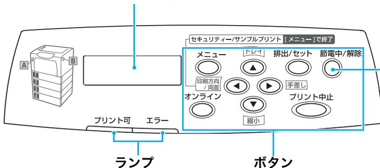
〈節電中 / 解除〉は、ボタンとランプの機能を持っています。節電モード (スリープモード) になると、操作パネルは、このランプだけが点灯します。
