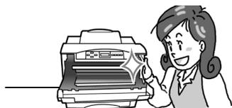
このプリンターはレーザー（レーザーダイオード）を使用しています。電源がONになっているときに内部をのぞいたり、鏡などを差し込んだりしないでください。万一、レーザー光が目に入ると失明するおそれがあります（レーザー光は目に見えません）。
