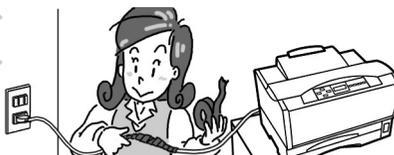
損傷した電源コードはすぐ同じものと取り替えてください。損傷部分を補修してお使いにならないでください。ビニールテープなどで補修した部分が過熱し、火災や感電の原因となるおそれがあります。
