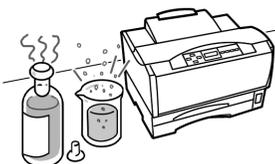
腐食性ガスの発生する場所、薬品類がかかるおそれのある場所には設置しないでください。部品が変形したり傷んだりして装置が正しく動作しなくなることがあります。
