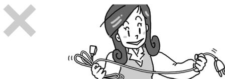
プリンターに添付されている電源コード以外のコードを使わないでください。電源コードに定格以上の電流が流れると火災になるおそれがあります。
