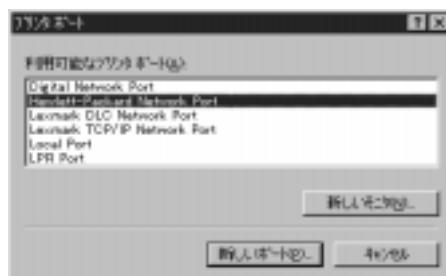
[ Hewlett-Packard Network Port ] が表示されない場合は、[ DLC ポートコントローラー ] サービスをインストールしてください。
