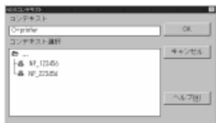
画面からプリントサーバが登録されているNDSコンテキストを選択して[OK]ボタンをクリックすると選択コンテキストがNDSコンテキスト欄に入力されます。[キャンセル]ボタンをクリックすると設定内容を保存せずに[NDSコンテキスト]ウィンドウを閉じます。
