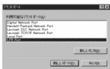
[LPR Port]が表示されない場合は、[Microsoft TCP/IP 印刷]サービスをインストールしてください。
