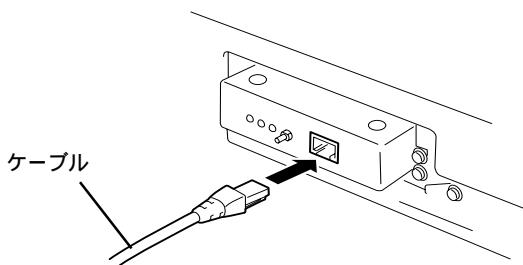
電源投入後、LANボードはネットワークの速度を自動的に検出し、10BASE-Tまたは100BASE-TXで動作します。
