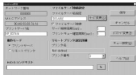
5 [ ファイサーバ接続設定 ]の[ ファイルサーバ名指定 ]にファイルサーバ名を入力するか[ サーバ変更 ]を押しファイルサーバリストから選択します。
