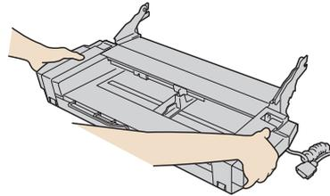
プリンタ前面にある左右のスタッド（突起）にシートフィーダの左右のツメを押し込みます。
