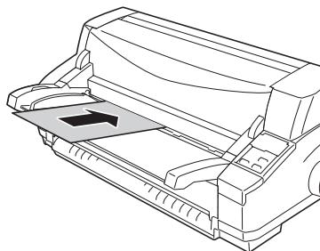
カット紙が自動的に吸入され、印刷可ランプが点灯します。カット紙の詳しいセット方法は「カット紙のセットと吸入」(33ページ) を参照してください。
