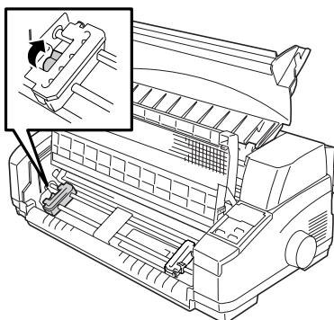
**7 左右のトラクタカバーを開け、連続紙を印刷する面を上にしてセットする。**
