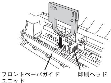
リボンがカードホルダと印刷ヘッドの間に入っていることを確認します。
