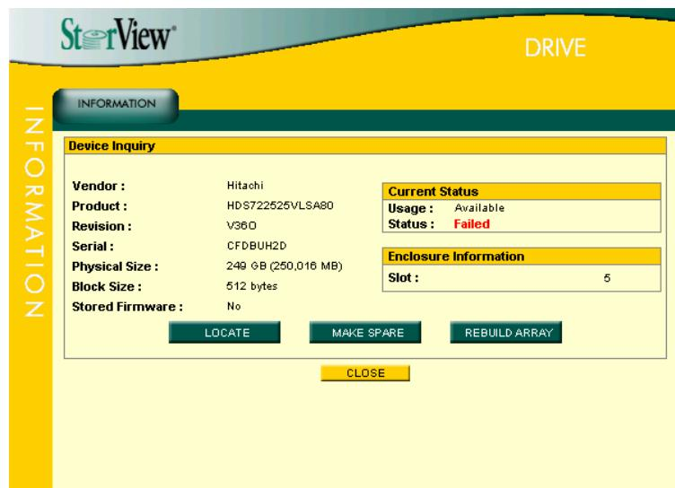
2. [REBUILD ARRAY]ボタンをクリックし、リビルドを実施するアレイを選択してください。
