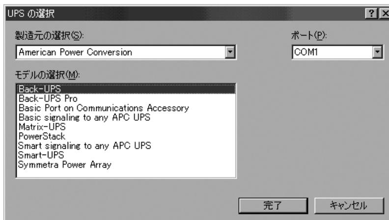
4. 次に「製造元の選択 (S)」のプルダウンメニューから「American Power Conversion」を選択すると、「モデルの選択 (M)」に UPS の機種が表示されるので「Back-UPS」を選択し、「完了」ボタンをクリックしてください。
