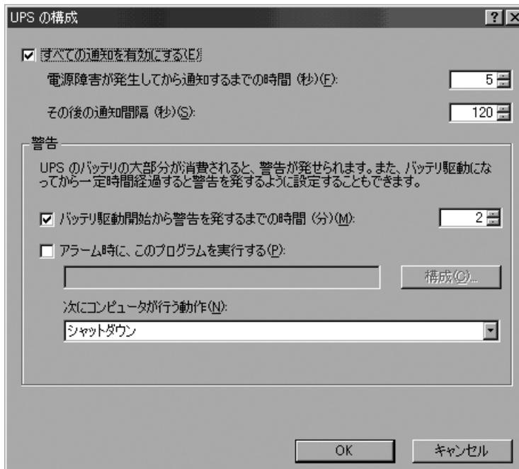
6. 設定が終わりましたら「OK」ボタンをクリックし、ダイアログボックスを閉じます。状態の欄の「現在の電源」が「AC 電源」になっていることを確認してください。
