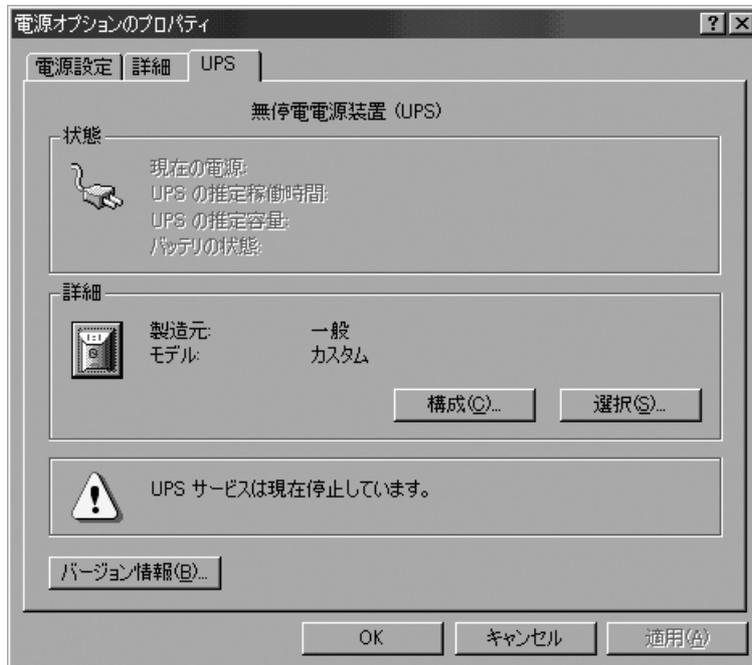
3. 詳細の欄の「選択 (S)」ボタンをクリックすると「UPS の選択」ダイアログボックスが表示されるので、「ポート (P)」のプルダウンメニューから UPS を接続した COM ポートを選択してください。
