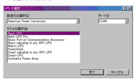
次に「製造元の選択(S)」のプルダウンメニューから「American Power Conversion」を選択すると、「モデルの選択(M)」に UPS の機種が表示されるので「Back-UPS」を選択し、「完了」ボタンをクリックしてください。
