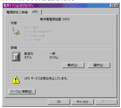
詳細の欄の「選択(S)」ボタンをクリックすると「UPS の選択」ダイアログボックスが表示されるので、「ポート(P)」のプルダウンメニューから UPS を接続した COM ポートを選択してください。
