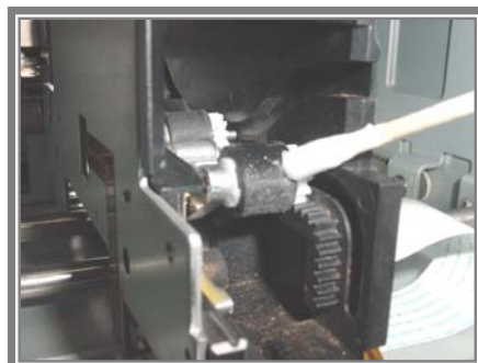
図 5-12 残り部分のクリーニング
