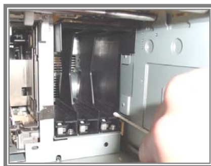
図 5-15 固定スロット内面のクリーニング
