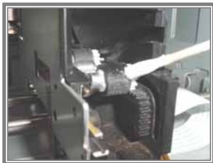
図 5-12 残り部分のクリーニング
