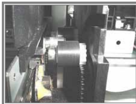
図 5-13 残り部分クリーニング後のローラー
