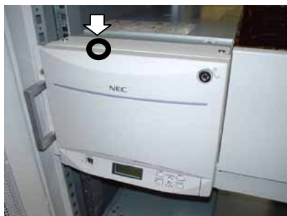
図 3-17 電子ロック解除キー・挿入口(前方にスライドさせた状態)
