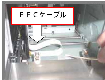
図 5-16 装置内部のクリーニング
