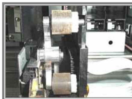
図 5-3 手前側に移動したローラー
