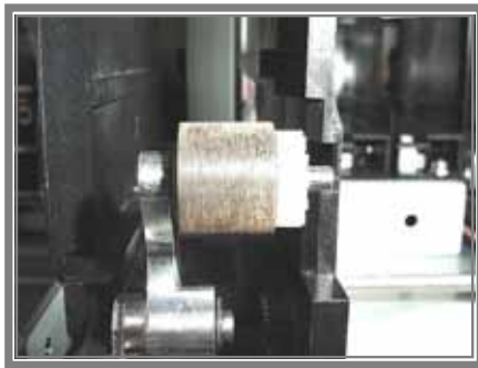
図 5-4 クリーニング前の上側ローラー
