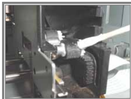
図 5-12 残り部分のクリーニング
