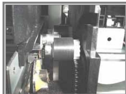
図 5-13 残り部分クリーニング後のローラー
