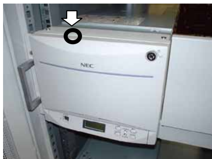
図 3-14 電子ロック解除キー・挿入口（前方にスライドさせた状態）
