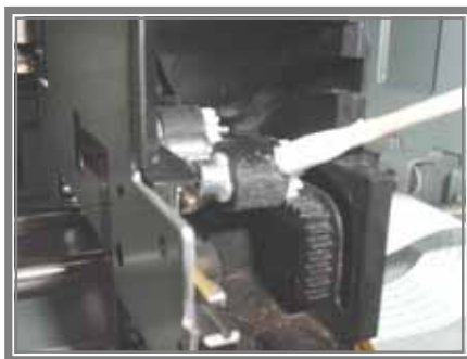
図 5-12 残り部分のクリーニング
