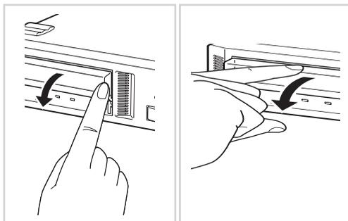
3. AITデータカートリッジを右図の向きにして本製品のデータカートリッジ挿入口に挿入する。
