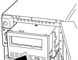
(3) 下図のように電源ケーブル、インタフェースケーブルを接続してください。取り付ける本体装置によっては、本製品を完全に取り付けスロットに挿入する前に接続する場合もあります。
