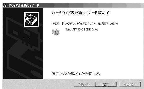
9. 「デバイスマネージャ」ダイアログボックスで、AITテープドライブユニットが表示されていることを確認する。
