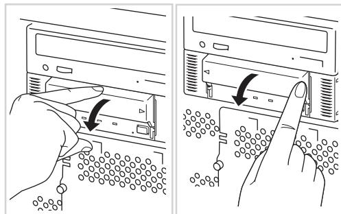
4. データカートリッジ挿入口からデータカートリッジを取り出し、防塵バーを閉める。
