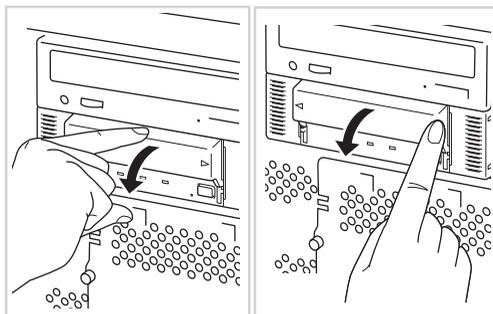
4. データカートリッジ挿入口からデータカートリッジを取り出し、防塵カバーを閉める。
