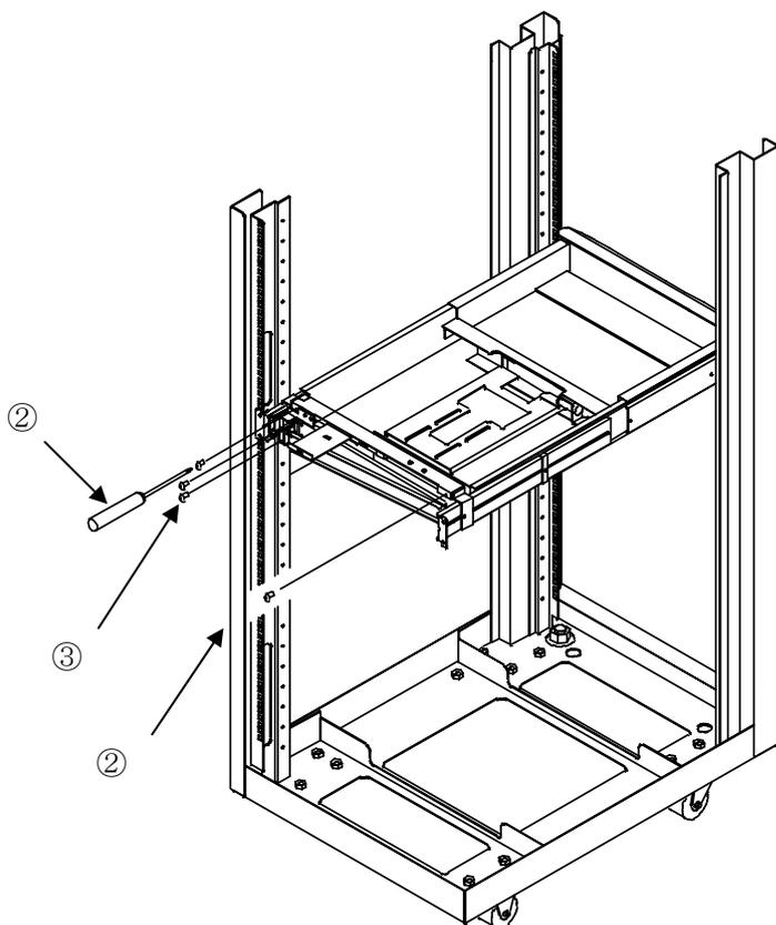
4) 本ユニットへ液晶ディスプレイ（LCD）／キーボード／マウスを取り付けます。
