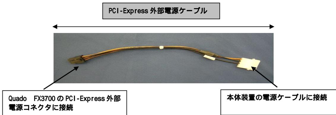
また、本体装置の電源ケーブルが不足する場合には別途添付してあります電源分岐ケーブルを使用して電源コネクタの口を増設してご使用してください。
