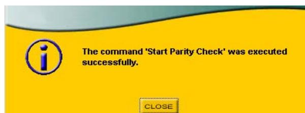
4. [CLOSE]ボタンをクリックして、ARRAY INFORMATION 画面を閉じます。メインスクリーンの Arrays セクションに進捗が表示されます。
